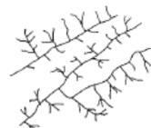
**b) Patrón enrejado.**- Sistema de corrientes subparalelas, usualmente sobre las fallas de la formación de rocas o entre rasgos topográficos paralelos recientemente depositados por el viento, agua o hielo.
