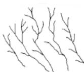
**d) Patrón paralelo.**- Se localiza en regiones con pendientes pronunciadas o con fuertes controles estructurales que marcan un espaciado regular y paralelo entre los canales.
